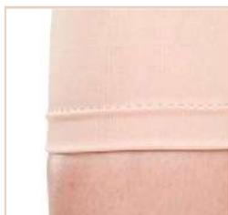
La tecnología Ultrasonic permite la unión de textiles por soldadura. El terminado con esta tecnología es muy duradero y la tela es menos propensa a rasgarse.
